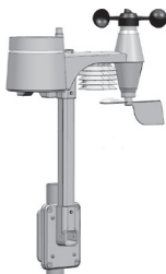
A. Montáž na tyč (průměr tyče 1"~ 1,3" (25 ~ 33 mm))
